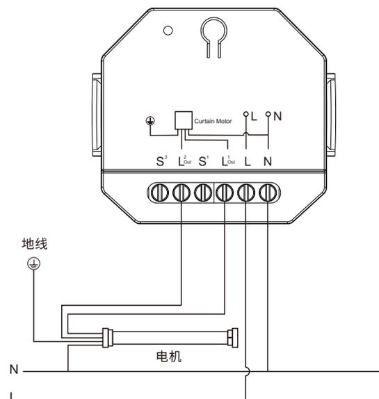
注：两位自复位开关分别控制正反转向，具体正反转向需根据实际窗帘电机接线决定。
