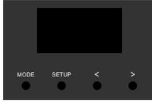
短按MODE键, 切换DMX解码器模式、调光器模式和RGBW控制器模式三种工作模式。
